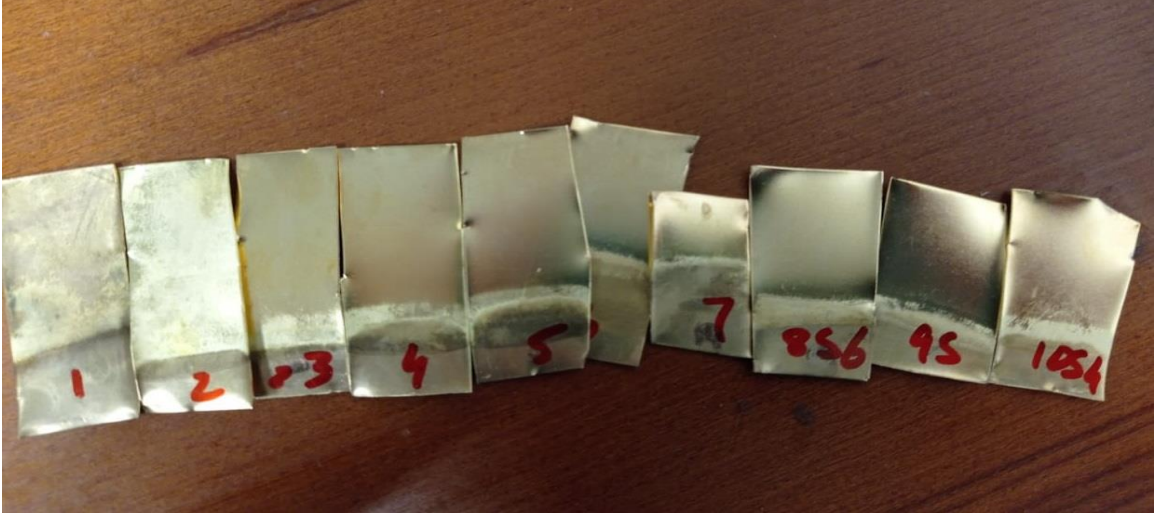
شکل 3.11 مختلف وولٹیجز پر پینل کی شیٹ کی الیکٹروپولشنگ
